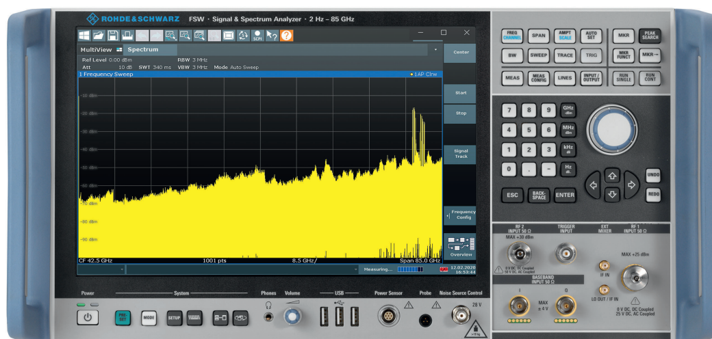
Bild 3: Die Software-Option Transientenanalyse erweitert um die Chirp-analyse liefert in einem Bild alle wichtigen Parameter eines FMCW-Signals. © Rohde & Schwarz
